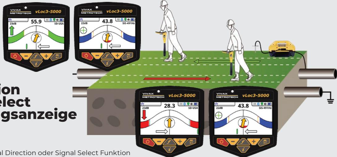
Mit der Vivax-Metrotech Signal Direction oder Signal Select Funktion wird die Signalrichtung (der Fluss des Signalstroms) durch eine Leitung bestimmt.
