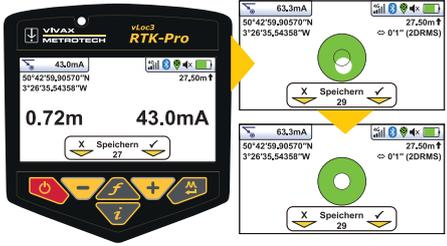
Zusätzlich zu den Ortungsansichten der vLoc3-Serie (Seite 11), bietet der vLoc3 RTK-Pro spezielle Ansichten zur Punkterfassung und Neigungskompensation sowie für die Attributsauswahl und Walk Back Funktion.
