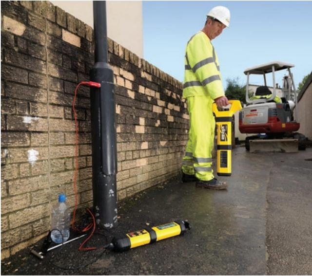
Der ultra-kompakte vScan Tx Sender kann separat erworben werden und ermöglicht im Zusammenspiel mit dem vScan Empfänger die aktive Ortung von metallischen Leitungen. Der Sender ist ausreichend leistungsstark für die meisten Anwendungen und bietet verschiedene Signalfrequenzen. Die Signaleinspeisung erfolgt im Direktanschluss, per Signalzange oder im Induktionsbetrieb. Zum Lieferumfang des vScan Tx Sender gehört das Anschluss-Set, Batterien sowie eine Tragetasche für Sender und Empfänger.
